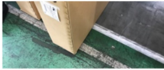
部品棚から部品がはみ出し白線を出している
